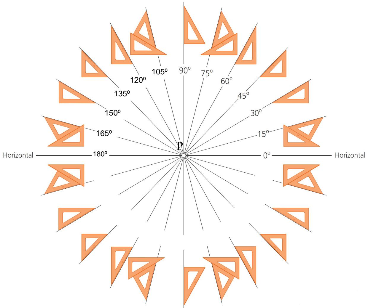
Para poder realizar el trazado de ángulos, conviene posicionar las reglas en un lugar despejado respecto del punto donde se quiere trazar el ángulo.
